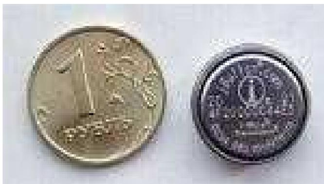
Вся электронная “начинка” такого регистратора – температурный датчик, часы, память, элемент питания и схема управления – размещается в герметичном металлическом корпусе MicroCAN, диаметром с рублевую монету.
