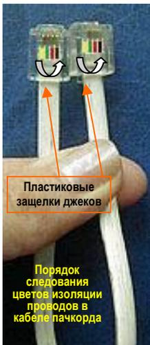
взгляде сверху на уже смонтированный прозрачный джек (со стороны защёлки фиксации джека в разъёме-гнезде), порядок следования проводников в кабеле сохранялся (слева направо цвета изоляции: жёлтый, зелёный, красный, чёрный).
