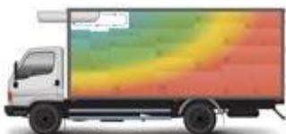
Зачастую, при погрузке не остается свободного места между коробками с товаром и стенами, потолком и полом фургона. В этом случае циркуляция воздуха блокируется, что приводит к перемораживанию продукции в местах близких к холодильному агрегату и перегреву в отдаленных.
