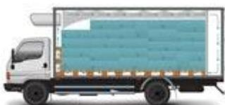
Если крепление испарителя рефрижераторной установки осуществляется не к потолку, а к фронтальной стенке фургона, то воздушный поток ввиду низкого расположения вентиляторов может упереться в груз. В этом случае потребуются проведение воздуховода от холодильного агрегата до задних дверей по крыше кузова. Воздуховоды также часто ставят на рефрижераторных полуприцепах, чтобы увеличить длину струи холодного воздуха.
