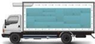
Циркуляция, как отмечалось ранее, образуется воздушным потоком, создаваемым вентиляторами испарителя холодильной установки. Когда груз размещен правильно, то поток холодного воздуха проходит в верхней части фургона и, отражаясь от задних дверей, по пути наименьшего сопротивления направляется к полу, по которому движется к фронтальной стенке, а затем по ней возвращается к рефрижераторному агрегату, прогоняется через теплообменник – остывает; после чего процесс повторяется снова.
