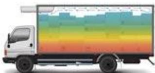
Многие также полагают, что для равномерного охлаждения груза по всему объему достаточно оставить свободное место между ним и крышей фургона. Однако, и в этом случае, продукция, размещенная внизу будет иметь температуру большую, чем требуется для её хранения и транспортировки, а находящаяся сверху – меньшую, так как будет интенсивно обдуваться холодильной установкой.
