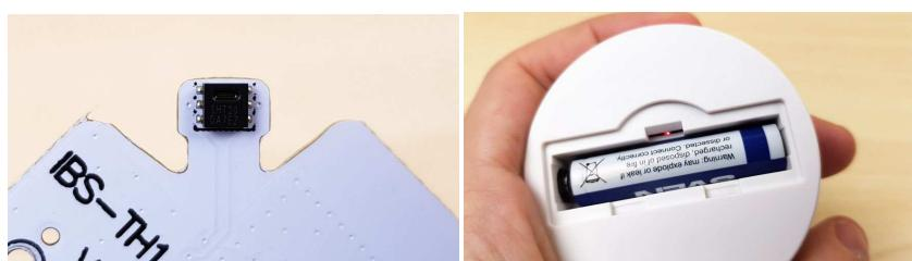
При установке в холдер логгера батареи питания на несколько секунд загорается встроенный светодиод (см. щель замка крышки холдера), который оповещает о том, что батарея имеет штатное напряжение, достаточное для эксплуатации устройства, и теперь логгер активен и готов к эксплуатации.
