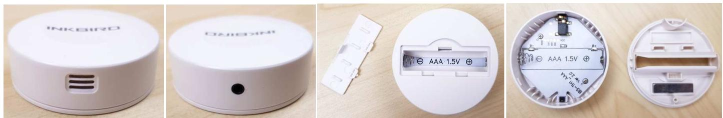
На плате электронной схемы логгера установлен чувствительный элемент микросхемы SHT20, непосредственно реализующий преобразование температуры и влажности. Он специально фиксирован около отверстия для доступа внутрь корпуса воздушной среды.
