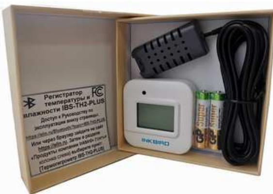
При необходимости эксплуатации логгера с внешним зондом разъём-вилку подключаемого зонда следует вставить в разъём-розетку, который расположен на правой грани корпуса прибора. При этом следует приложить разумные усилия, так, чтобы вилка подключаемого зонда полностью (до упора) вошла в разъём-розетку прибора.
