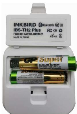
Питание логгера IBS-TH2-PLUS осуществляется от двух сменяемых батарей типоразмера AAA, которые устанавливаются в батарейный отсек (холдер) с надёжно закрывающейся крышкой, расположенный с тыльной стороны корпуса IBS-TH2-PLUS. Также в заднюю крышку корпуса логгера встроены два небольших магнита, которые позволяют зафиксировать устройство на плоской массивной железной поверхности.
