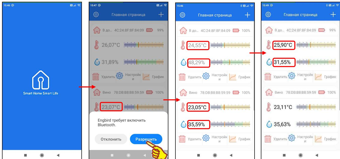
Изначально связь между гаджетом и логгерами не установлена. Поэтому текущие цифровые значения контролируемых логгером параметров отображаются шрифтом серого цвета (см. главу «Главная страница»). Если цвет отображения текущих цифровых значений контролируемых логгером параметров изменился с серого на чёрный, значит связь между гаджетом и логгером установлена. И теперь на экране гаджета отображаются последние зафиксированные логгером значения контролируемых параметров.
