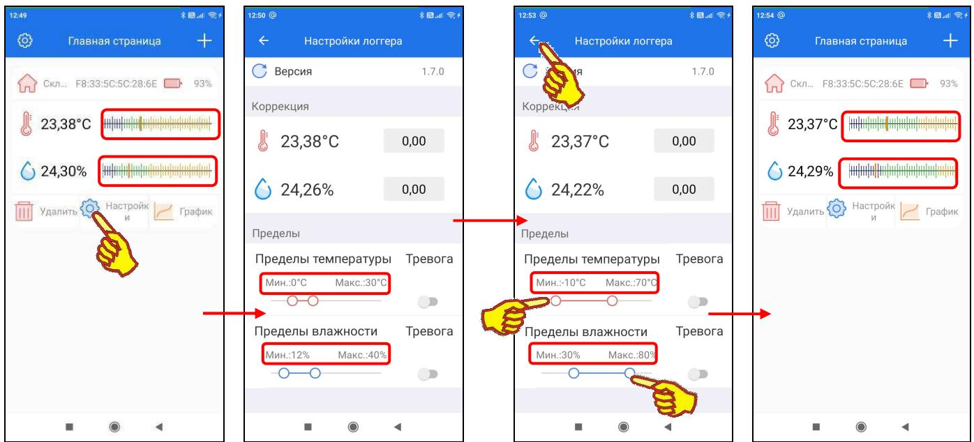
Для включения механизма оповещения о нарушении заданных пределов необходимо в разделе «Пределы» страницы "Настройки логгера" сдвинуть переключатель [Тревога] канала температуры (для IBS-TH2(T) и IBS-TH2(TH)) и/или влажности (для IBS-TH2(TH)) в активное состояние (т.е. вправо). Соответствующий переключатель активен, если его изображение подсвечено зелёным цветом.
