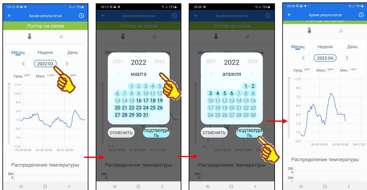
При касании любой точки кривой графического изображения отображается выноска, содержащая значение измеренного логгером результата в градусах или процентах, и момент
