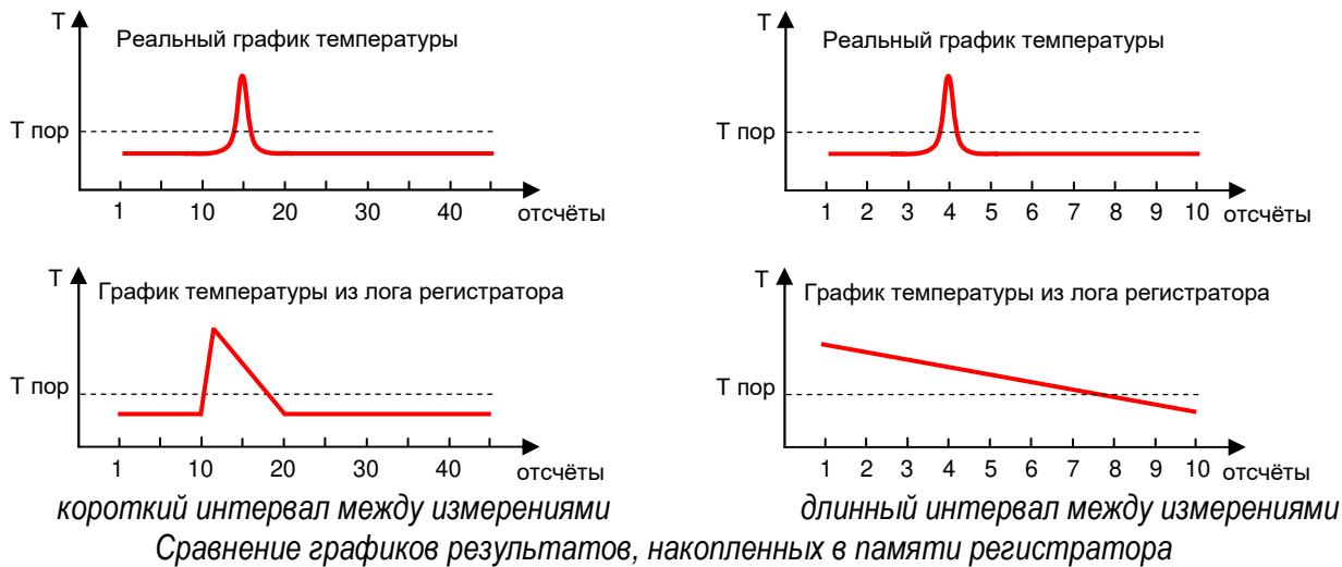
Однако следует отметить, что инерционность корпуса логгера может в зависимости от выбранного темпа измерений незначительно или значительно скрывать описанный выше эффект от интерполяции результатов как для внутреннего датчика температуры, так и для внутреннего датчика влажности логгера.
