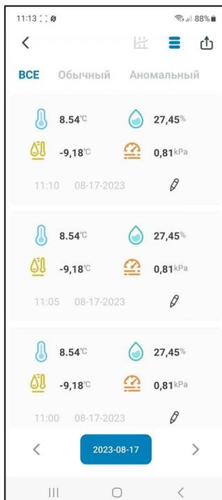
Изначально объём информации, выводимой на странице таблиц результатов, определяется временной развёрткой графического изображения на странице графиков. При этом последний по времени зафиксированный логгером результат расположен на самой верхней строчке таблицы, а остальные значения, зафиксированные до этого, располагаются последовательно в строках таблицы сверху вниз.
