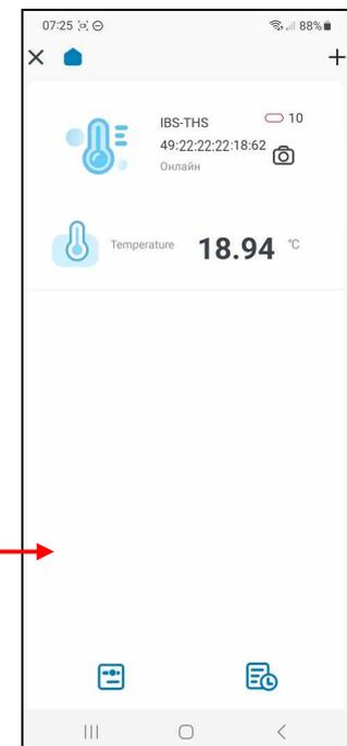
Вторая панель главной страницы логгера связана с отображением текущего значения температуры внутреннего датчика или зонда в цифровой форме, с двумя значащими разрядами после запятой и с указанием размерности. Эта панель актуальна для логгеров IBS-### любой модификации.
