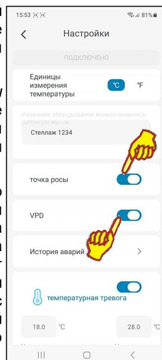
Для включения механизма расчёта и отображения значений *дефицита давления пара (VPD)* необходимо сдвинуть переключатель кнопки [VPD] в активное состояние (т.е. вправо). Температура и влажность являются определяющими факторами для дефицита давления пара, который оказывает значительное влияние на здоровье растений. Давление пара - это давление, при котором жидкость превращается в пар.
