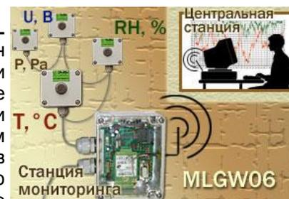
Комплекс iBRCG состоит из множества удалённых станций мониторинга, каждая из которых обслуживает одну линейную 1-Wire-сеть регистраторов ТЕРМОХРОН (до 16 устройств) или регистраторов iBDL (до 8 устройств), и центральных станций мониторинга. В состав комплекса можно также включить мобильные сотовые телефоны легальных абонентов.
