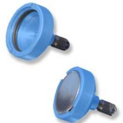
Уплотнительное кольцо капсулы изготовлено из материала, утвержденного Управлением по контролю за продуктами и лекарствами США (FDA (<http://www.fda.gov/>)) для прямого контакта с пищевыми продуктами. Оно плотно закрывает лицевую поверхность логгера iButton, одновременно позволяя жидкости омывать основную часть его корпуса, непосредственно связанную с датчиком температуры. Новое приспособление имеет следующие габариты Ø21,0 мм, высота: 24 мм, вес: 4.7 г без установленного логгера.
