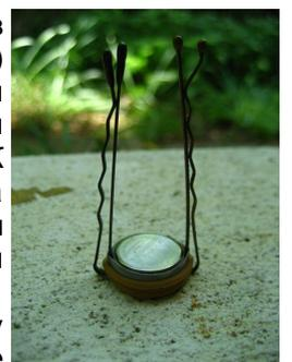
Для установки в гнездо на каждый логгер надевалось резиновое кольцо, затем между корпусом прибора и кольцом пропускались обыкновенные заколки для волос, после чего дно гнезда протыкалось концами заколок. Такая,
