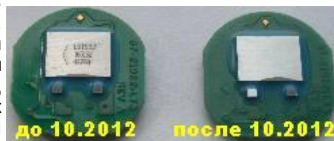
Внешний вид электронной платы логгера DS1922L#F5
