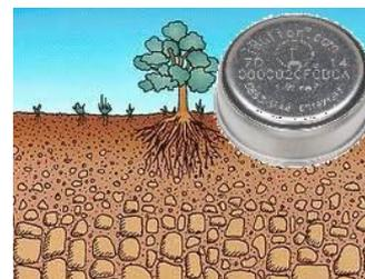
Регистраторы iButton — эффективный инструмент для мониторинга температуры и влажности почвы, а также при гляциологических исследованиях.
