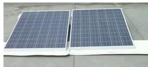
Кроме того, термолоттеры ТЕРМОХРОН, используемые для тестирования солнечных батарей совместно с тепловизором, показали эффективность покрытия AS-LR против т.н. горячих точек, которые образуются в локальных зонах из-за дефектов кристаллических структур кремния, неизбежных при изготовлении фотоэлектрических панелей. При этом было зафиксировано, что, разогрев локальных зон, защищённых новым покрытием изделий, был на 30°C до 45°C меньше чем у солнечных батарей, незащищённых покрытием.
