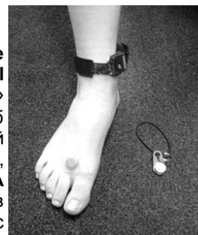
помощью температурных логгеров iButton. Температура стопы регистрировалась с помощью логгера модификации DS1921H-F5, имеющего диапазон измерений от +15°C до +46°C и чувствительность ±0,125°C, температура окружающей среды фиксировалась логгером модификации DS1921G-F5 с диапазоном регистрации от -40°C до +85°C и чувствительностью ±0,5°C.
