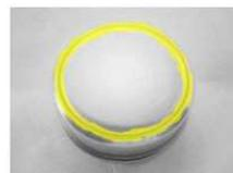
Дополнение: если во время эксплуатации возможны лишь кратковременные периоды с повышенной влажностью среды, используйте воскоподобные или парафиноподобные вещества для защиты. При этом рекомендуется сначала нанести покрытие в среде с низкой влажностью, а уже после этого проверить логгер на стойкость к воде.
