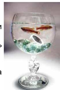
Обратите внимание: на рисунке выше Термохрон в чехле DS9720W используется под водой, но такое использование под водой не может быть продолжительным. Кроме того, играет роль величина давления воды. Обычно такое средство защиты Термохрона используют в качестве меры водозащиты не непосредственно в воде, а в местах, где присутствует вода.
