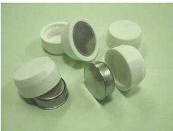
Материалом водозащитного чехла DS9720W является силиконовая резина. Допустимый температурный диапазон использования составляет: от -40°C до +100°C. (Внимание! Этот диапазон показывает диапазон температуры окружающей среды (воздуха), где материал не меняет своих основных свойств. Однако, это не даёт никаких гарантий успеха его использования в замороженной или кипящей жидкости).
