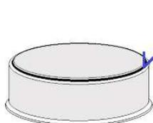
Если нет ошибки в ориентации логгера при подключении, причина может быть связана с отказом изделия или с окончанием срока его службы. Кроме того, как показано на иллюстрации слева, на корпусе логгера имеется желобок (канавка), и такой ситуация может проявиться, если в этот желобок попадает какой-то проводящий мусор (например, железный порошок или стружка).
