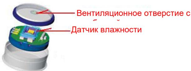
Примечание. Если вентиляционное отверстие устройства ГИГРОХРОН заблокировано водой или пылью, правильно произвести измерения влажности невозможно.
