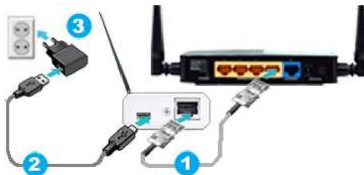
**Схема 2б.** Ethernet-порт менеджера соединяется патчкордом (1) с LAN-портом Wi-Fi-роутера. USB-порт Wi-Fi-роутера подключается с помощью USB-кабеля (2) к miniUSB-порту менеджера.
