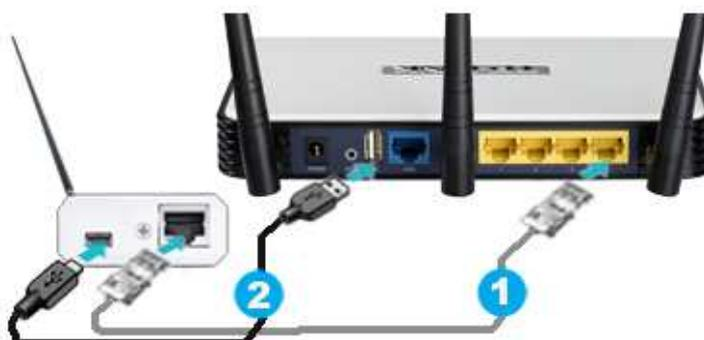
**Схема 2в.** Ethernet-порт менеджера соединяется патчкордом (1) с LAN-портом Wi-Fi-репитера (например, TL-WA850RE или TL-WA855RE). Сетевой адаптер питания (3) подключается с помощью USB-кабеля (2) к мини-USB-порту менеджера, и вставляется в расположенную рядом с ним электророзетку. Если конструкция репитера предусматривает наличие в его составе проходной электророзетки, то сетевой адаптер питания (3) может быть вставлен непосредственно в проходную электророзетку на корпусе Wi-Fi-репитера.
