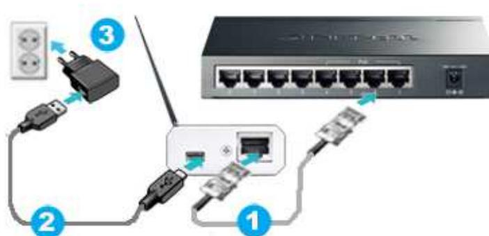
**Схема 1б.** Один из пары репитеров, исполняющих проводку Интернета через электросеть ~220В (например, адаптеры семейства PowerLine: TP-LINK TL-PA2010P или TL-PA4010), подключается посредством патчкорда (1) к «LAN»-порту кабельного модема, DSL-модема, или проводного маршрутизатора (роутера), и вставляется в расположенную рядом с ним электророзетку.
