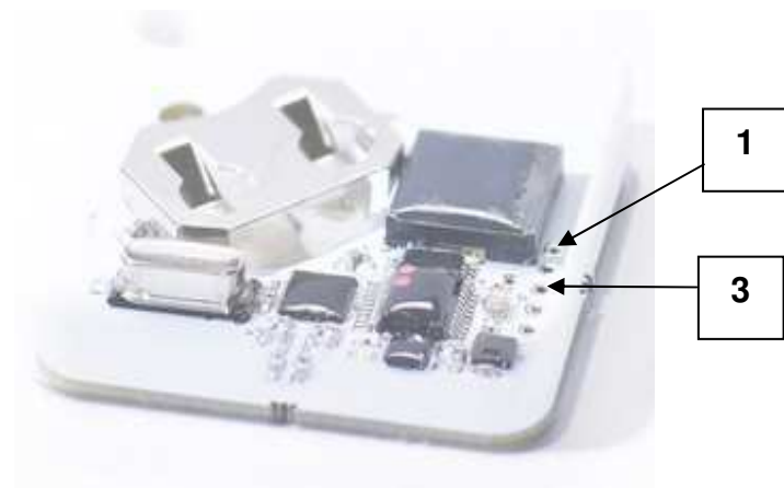
Требующие замыкания контактные площадки на плате сенсорного тега
