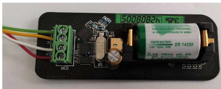
Рис. 3.5 – Плата тега с подключённым к клеммнику зондом Probe S (вариант 3)
