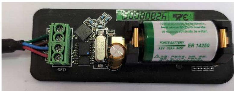
Рис. 3.3 – Плата тега с подключённым к клеммнику зондом Probe S (вариант 1)
