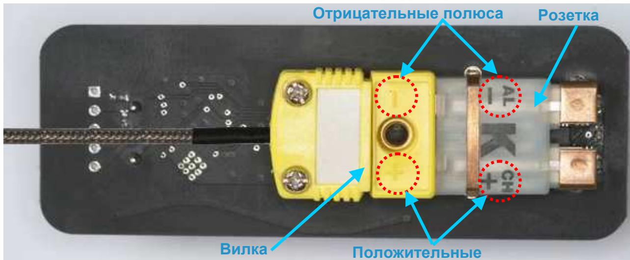
Рис. 5.5 – Разъём типа «Омега» на плате тега в сборе
