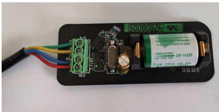
Рис. 3.2 – Плата тега с подключённым к клеммнику зондом Probe S
