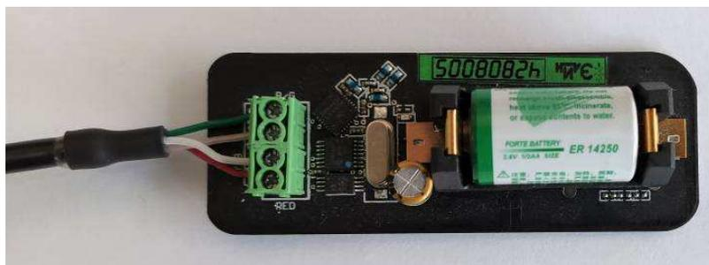
Рис. 3.4 – Плата тега с подключённым к клеммнику зондом Probe S (вариант 2)
