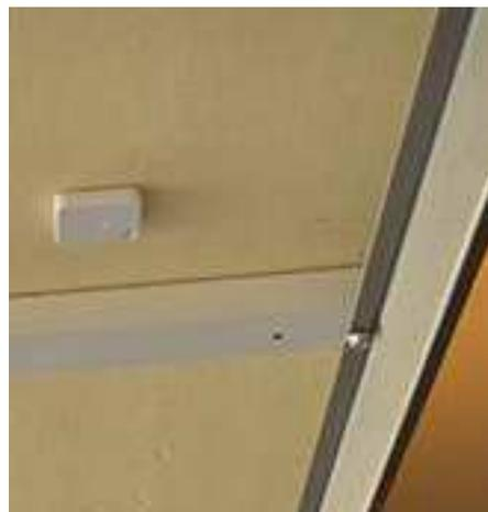
**Способ 3.** Разъёмное крепление тега к плоской поверхности может быть исполнено посредством застёжки "репейник" (или "липучка"). Например, застёжки Uline/S-19574, выполненной в виде двух квадратных пластин с размерами 25мм×25мм (одна из сторон каждой такой пластины оснащена скотчем, для неразъёмного крепления к плоскости соединяемых поверхностей).
