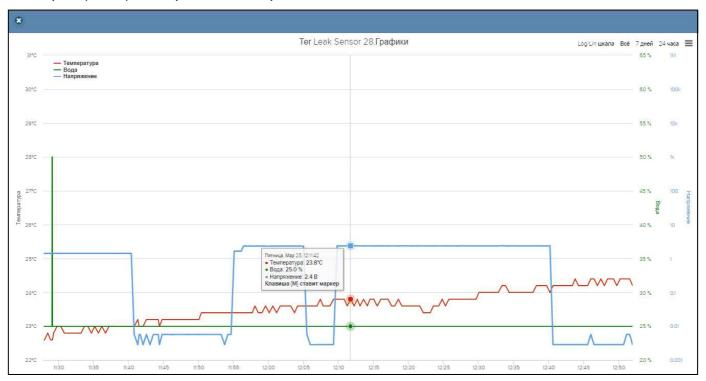
Отдельная кнопка [Log/Lin шкала] позволяет менять масштаб отображения кривой напряжения, используя или линейную шкалу, или логарифмическую шкалу.
