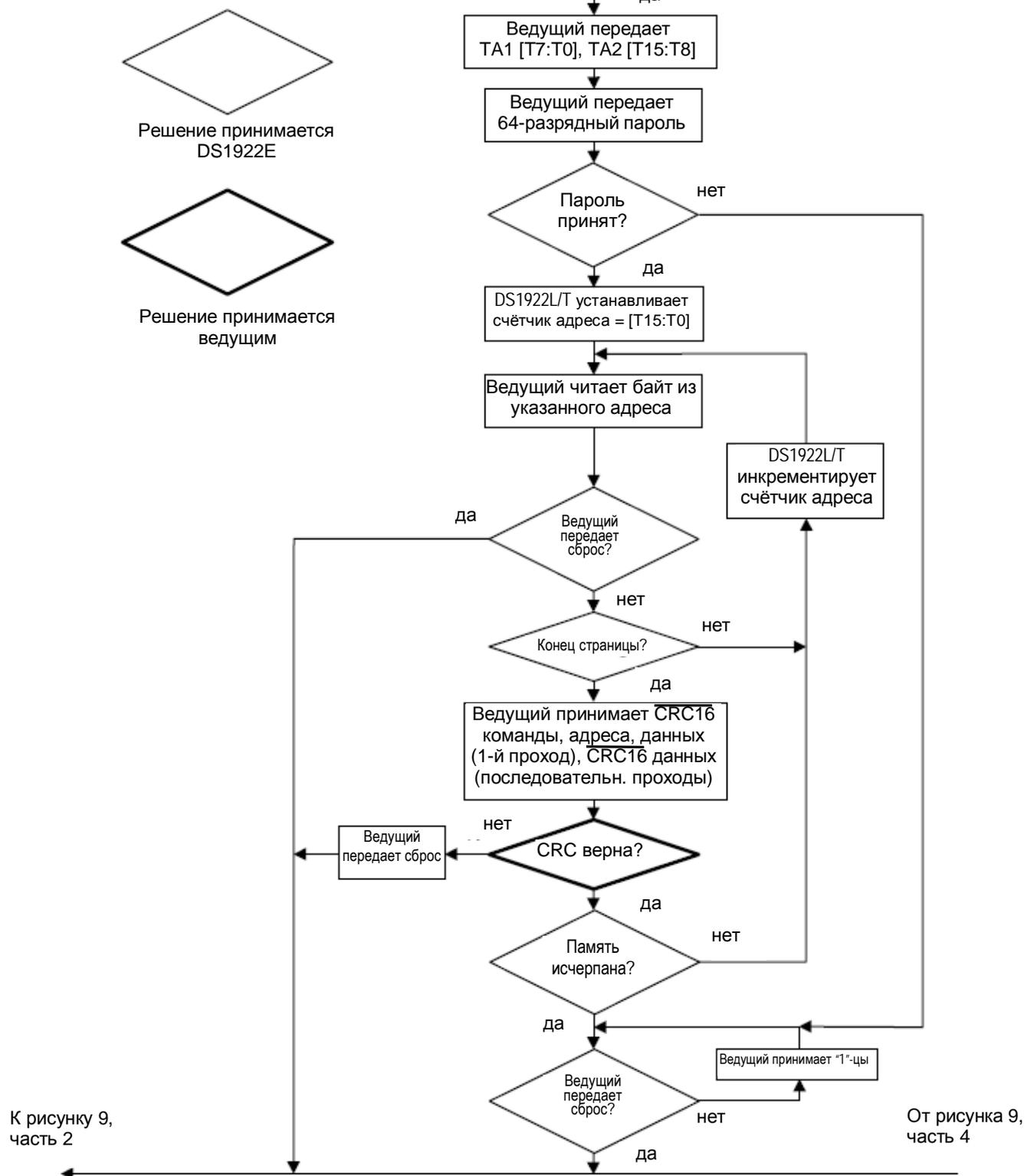
Рис.9-4 Бок-Схема Функций Памяти/Управления
