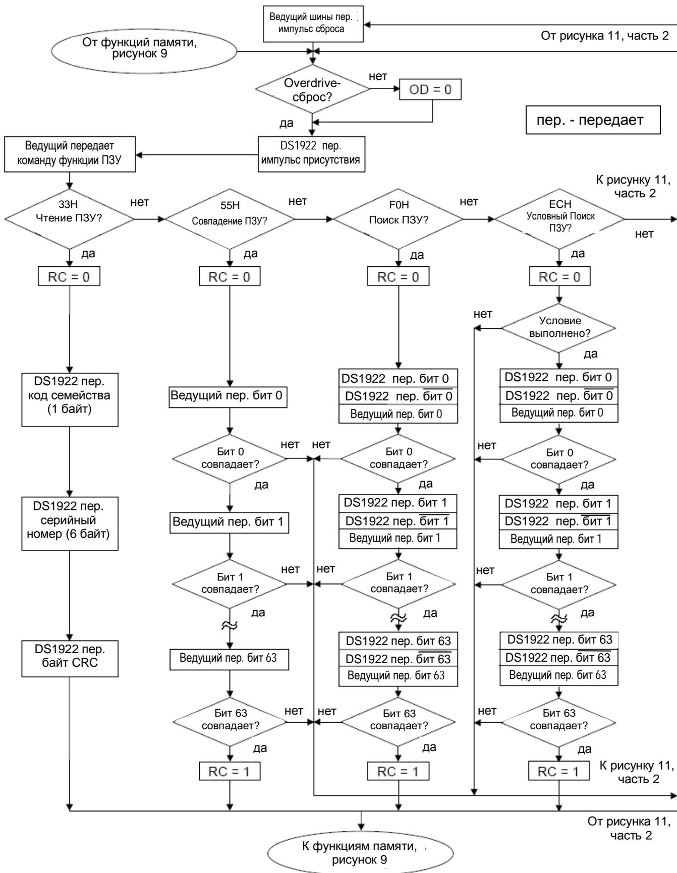
Рис. 11-2. Блок-Схема Функций ПЗУ
