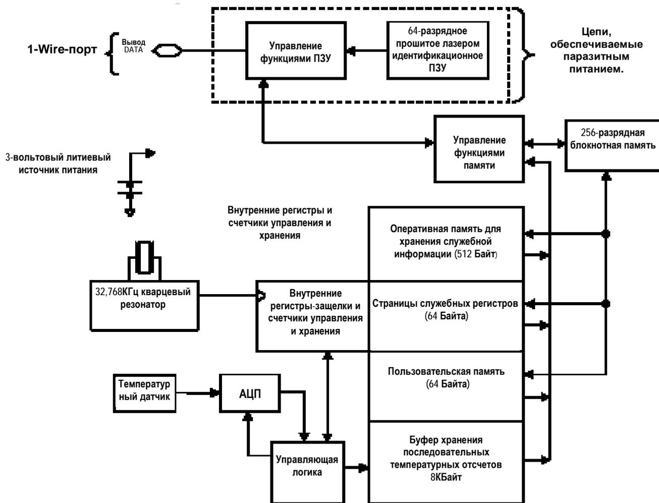
**Рис. 2. Структура Протокола Обмена Устройств DS1922L/DS1922T**
