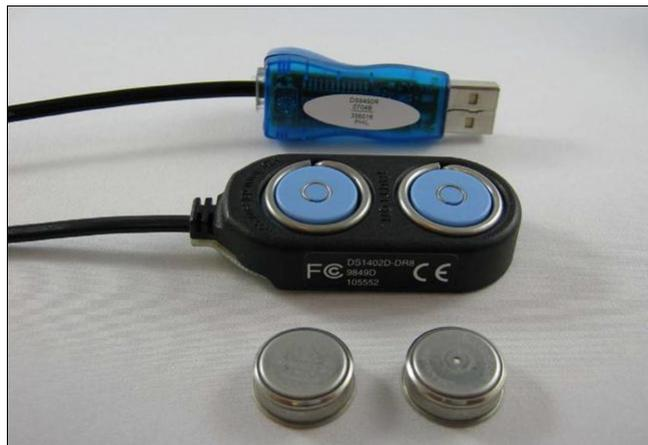
Рис.1 – Снизу вверх: логгеры iButton, приемное устройство Blue Dot, USB-адаптер.
