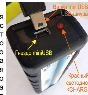
комплект поставки прибора iB-Reader) выполняется только заряд встроенного аккумулятора (см. главу «Зарядка аккумулятора»). Непосредственно соединение между miniUSB-гнездом прибора и USB-гнездом USB-порта компьютера или USB-гнездом зарядного устройства выполняется посредством USB-шнура. Роль USB-шнура исполняет входящий в комплект поставки считывателя iB-Reader стандартный удлинитель-переходник типа «USB A-Plug – miniUSB A-Plug».
