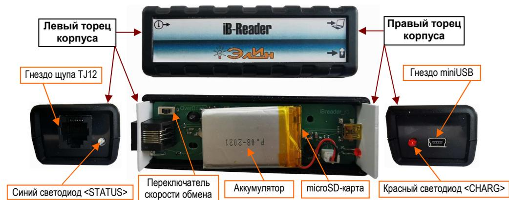
Разъём для подключения к прибору щупа сопряжения с логгерами iButton (телефонное T12-гнездо (6p6c)) и разъём для подключения к прибору USB-шнура (miniUSB-гнездо), а также индикационные светодиоды закреплены на плате и выведены на боковые торцы корпуса прибора. Также на плате прибора имеется механический переключатель, состояние которого определяет скорость информационного обмена при взаимодействии считывателя с обслуживаемыми логгерами iButton.
