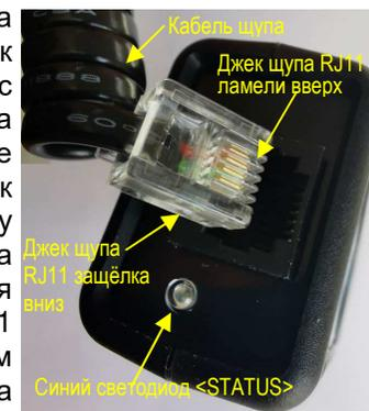
При обеспечении информационного обмена между считывателем iB-Reader и подлежащим обслуживанию логгером iButton любой из модификаций DS1921#/DS1922#/DS1925, следует подносить приёмное гнездо щупа к корпусу “таблетки” со стороны надписей, выгравированных на её поверхности. А при обеспечении информационного обмена между считывателем iB-Reader и подлежащим обслуживанию логгером iButton модификации DS1923, следует подносить приёмное
