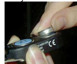
Работа с устройствами iButton, к классу которых относятся регистраторы iBDL, значительно упрощается при закреплении корпуса F5 cap в универсальном держателе DS9093N, который имеет форму брелка для обычных механических ключей. В этом случае процедура установки и изъятия «таблеток» из приёмного зажима Blue Dot значительно облегчается, благодаря наличию своеобразного пластикового «рычага», роль которого играет держатель DS9093N.
