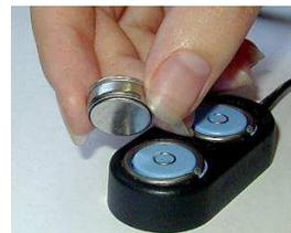
детектирует это и инициирует под управлением программного обеспечения обмен информацией между компьютером и логгером iButton. Подносить обслуживаемый регистратор к приёмному зонду следует таким образом, чтобы его корпус вошёл в приёмную часть зонда (голубую пружинящую фишку). При этом голубая фишка должна совпадать с передней (центральной) частью корпуса «таблетки» iBDL, которая отделена полипропиленовой изолирующей вставкой от задней части корпуса, оснащённой
