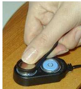
Для того, чтобы закрепить устройство, упакованное в корпус F5 cap, в брелке DS9093N, необходимо опустить пластиковый держатель на 2÷3 минуты в кипяток, а затем пропихнуть в отверстие
