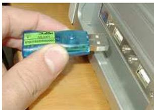
**Внимание! Конструкция адаптера ML94S исключает какие-либо механические воздействия на их корпус после подключения к компьютеру. Т.е. запрещается деформировать адаптер, подключённый к разъёму USB-порта, отклоняя его корпус более чем на 5° от перпендикуляра к плоскости корпуса системного блока PC.**
